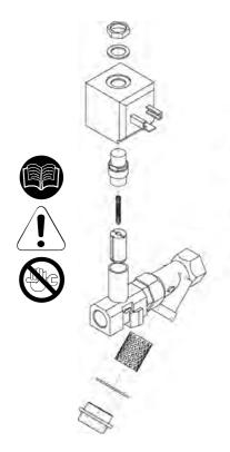
Pulizia dell'elettrovalvola di scarico condensa Cleaning of the drain solenoid valve Instandhaltung des ablass-elektroventiles Nettoyage de la electrovanne de decharge Limpieza de la valvula de descarga
